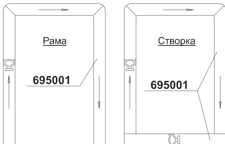
Схема установки уплотнителя под стекло и стеклопакет
